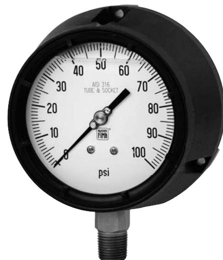
En caso de fugas o rotura del elemento elástico, el operario está protegido por una célula de seguridad "solid-front" en acero inox, detrás de la esfera y con una tapa posterior que es expulsada en caso de rotura. Son normalmente utilizados en la industria química, petroquímica, centrales convencionales.
